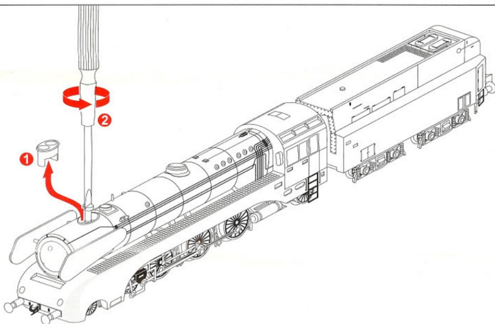
Kessel mit Umlauf anheben und vom Fahrrahmen abnehmen.
